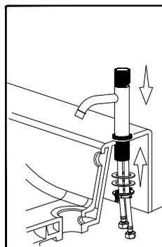
6. Затяните винты отверткой.
