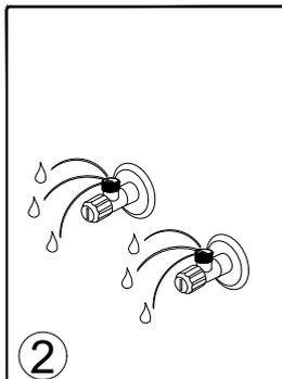
2. Промойте водопроводные трубы в течение 30–60 секунд, чтобы удалить возможные загрязнения.
