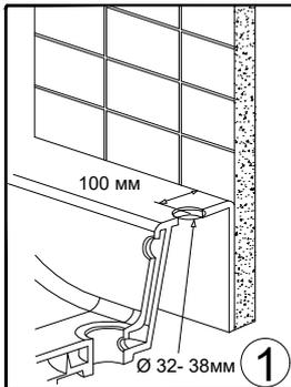
1. Просверлите отверстие в столешнице диаметром 33–38 мм.
