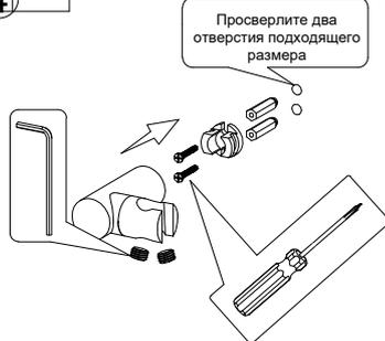
4. Закрепите держатель душа (поз. 6) на стене с помощью отвертки.
