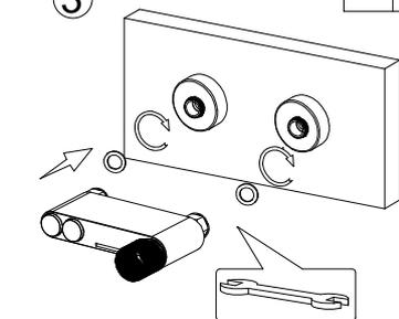
3. Установите резиновые уплотнители на гайки смесителя (поз. 1) и закрепите смеситель на эксцентриках (поз. 2) с помощью гаечного ключа.
