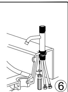
7. Подключите свободные концы шлангов (поз. 4) к угловым вентилям, затянув их гаечным ключом (поз. 5).
