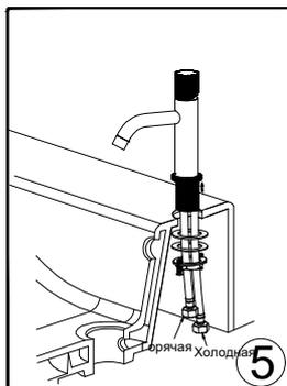
5. Вкрутите резьбовую втулку (из крепежного комплекта) в корпус смесителя и затяните.
