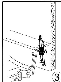
3. Проденьте крепежные элементы в указанном направлении через гибкие шланги (поз. 5), затем протяните через отверстие в столешнице снизу вверх.
