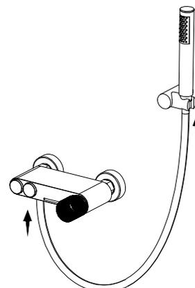
5. Подключите шланг для душа (поз. 5). Для этого один конец шланга соедините со смесителем (поз. 1), а второй – с лейкой (поз. 4).
