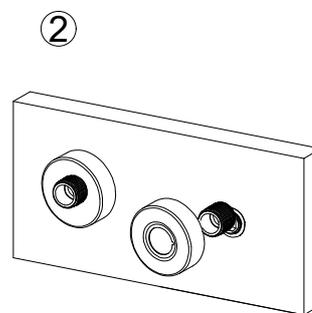
2. Прикрутите настенные отражатели (поз. 2) к эксцентрикам (поз. 2).
