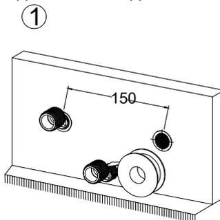
1. Обмотайте лентой резьбовые соединения эксцентриков (поз. 2) и вкрутите их в водопроводные выходы на стене. После этого промойте водопроводные трубы в течение 30–60 секунд, чтобы удалить возможные загрязнения.
